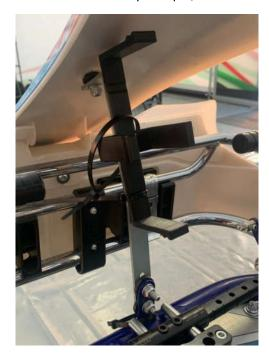
2) Placez la batterie dans le boîtier et verrouillez-la avec le ruban rouge fourni.
