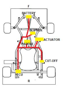
3) Vous pouvez couper puis isoler avec du ruban isolant les parties de câble non utilisées pour le karting en vous référant aux détails du diagramme électrique ci-joint (EFFECTUER CETTE OPÉRATION SANS ALIMENTATION!);
